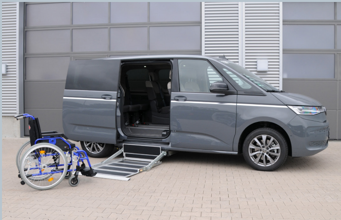
Die seitliche Auffahrmöglichkeit der Liftplattform mit der flachen Seitenkante spart Platz bei der Auffahrt mit dem Rollstuhl.
